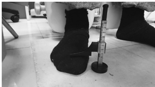
図2. ハイトゲージによる足趾高計測
